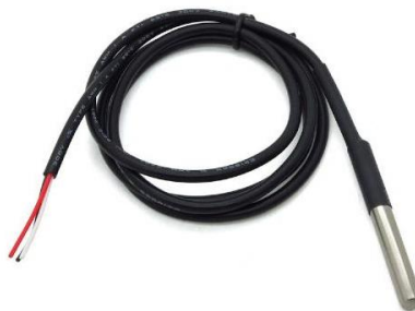
Figura 9. Sensor de temperatura DS18B20 utilizado en el prototipo.
