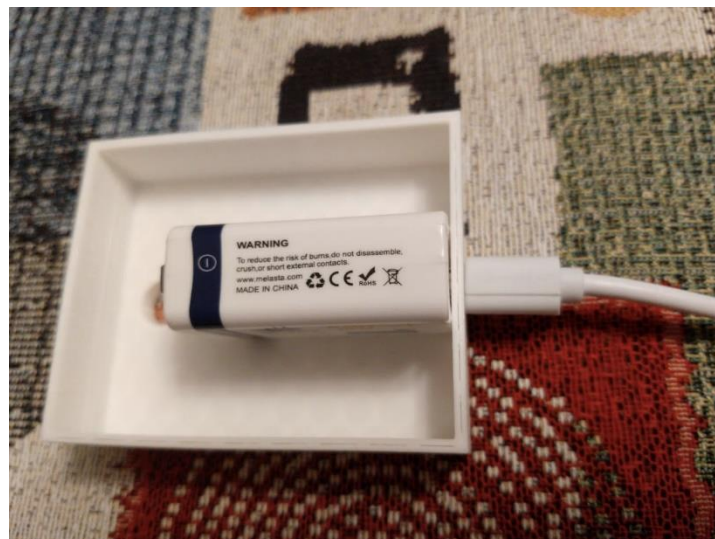
Figura 19. Batería recargable externamente.
