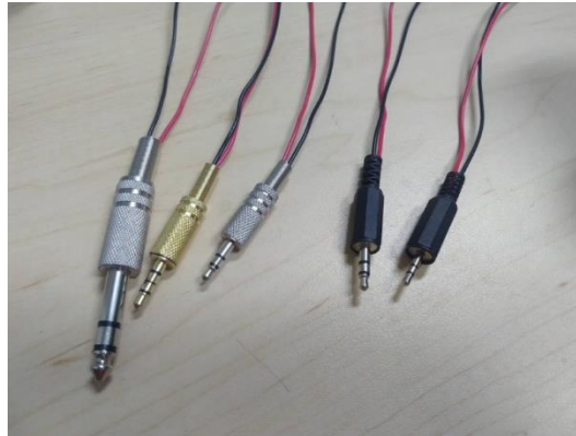
Figura 11. Diferentes modelos de electrodos con conectores de audio cable.
