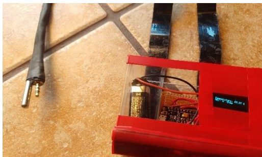
Figura 16. Primer prototipo inalámbrico con comunicación wireless y pantalla oled que refleja simultáneamente las mediciones de resistencia y temperatura. a) carcasa de acrílico, b) modo de uso.
