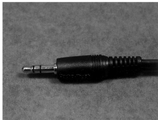
Figura 10. Jack de audio propuesto como probeta para la medición de la resistencia eléctrica en ratas (Ramos et al, 2001).
