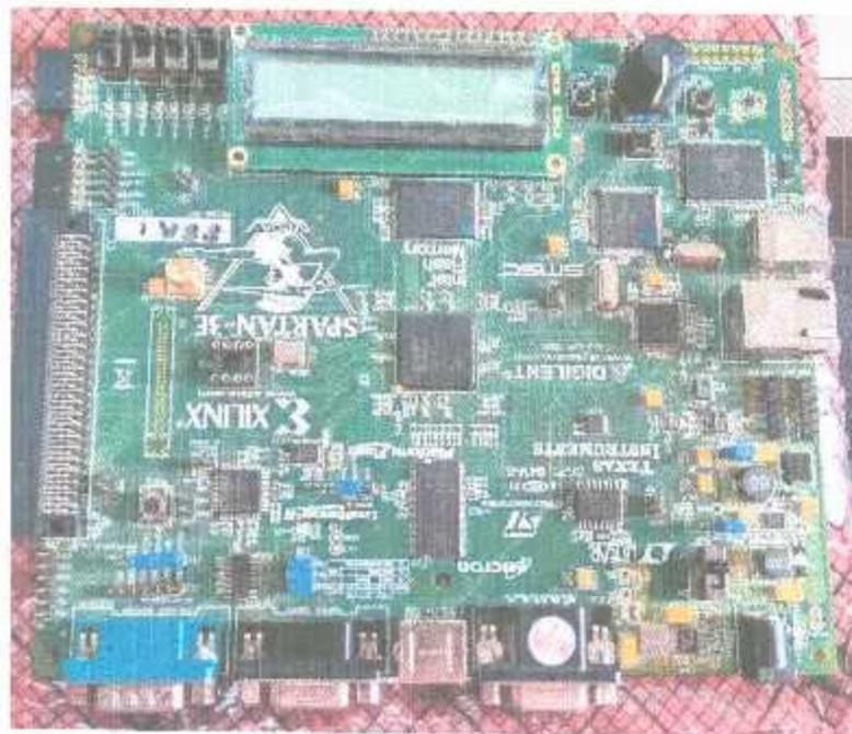
Figura 3.4 FPGA Spartan 3E usada para la implementación
