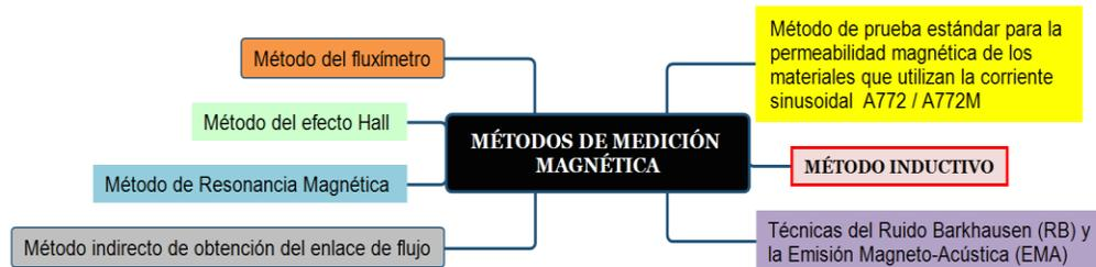
Figura 1.8. Métodos y técnicas de caracterización magnética encontradas en la literatura.
