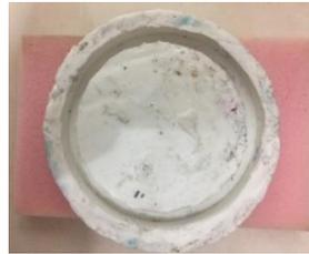
Figura 3.6. Molde de silicona para un núcleo toroidal normalizado.
