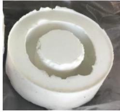
Figura 3.5. Molde de silicona de un núcleo de ferrita convencional.
