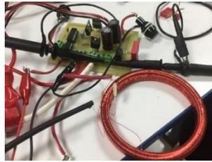
Figura 6.10. Circuito inversor utilizado para las pruebas.
