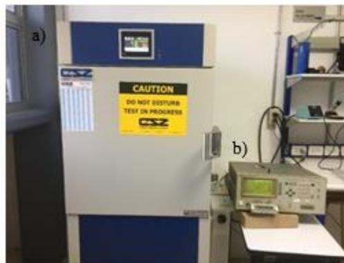
Figura 4.2. Aparatos eléctricos: a) La cámara micro climática, b) El medidor de inductancias.
