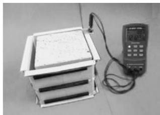
Figura 1.9. Configuración del método inductivo [35].
