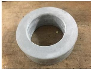
a) Acabado de un núcleo o pieza maquinada y lijada manualmente
