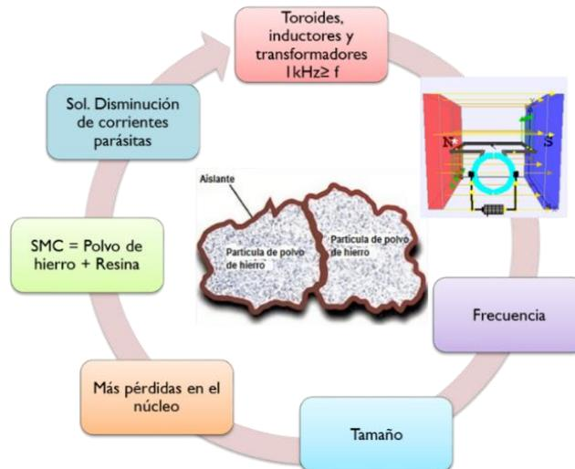
Figura 1.6. Factores más importantes en la composición de un SMC hierro-resina.
