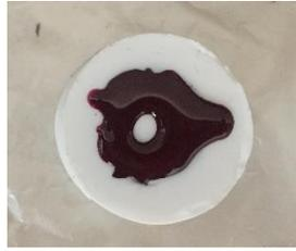
a) El vaciado de la mezcla en el molde de silicona de una sola cara no es preciso
