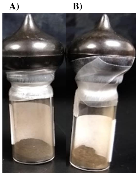
Figura 6.8. Partículas de magnetita A) sintetizadas y B) modificadas por inmersión con Qts al 0.02%. Se sintetizo al PA de 0.30 y PC de -0.92 V vs Hg|Hg 2 Cl 2 en KCl 0.5 M
