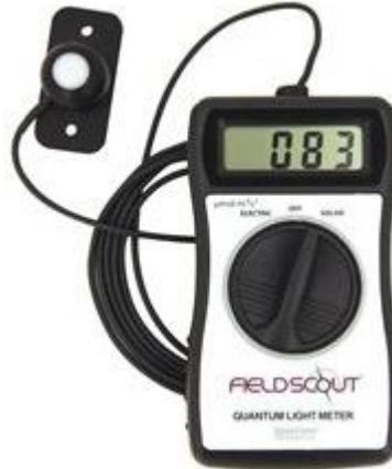
*Figura 9.- Instrumento tipo Quantum [70].*
