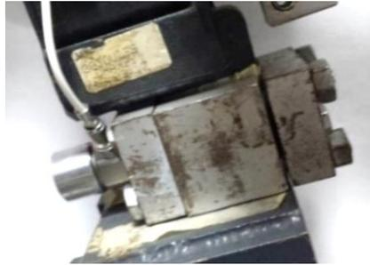
*Figura 4.16 Instalación de la celda de carga Kistler 9712A-500 en el péndulo.*
