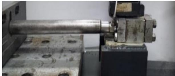
*Figura 4.17 Montaje de la barra de acero para la calibración.*
