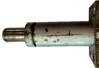
Figura 4.1 Disipador de energía.
