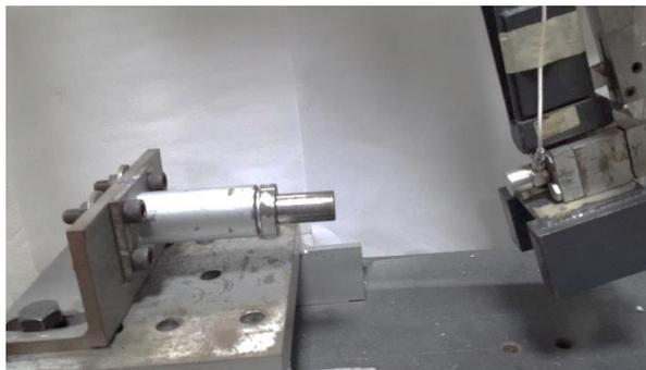
*Figura 5.1 Montaje del disipador de energía en el péndulo de Charpy.*
