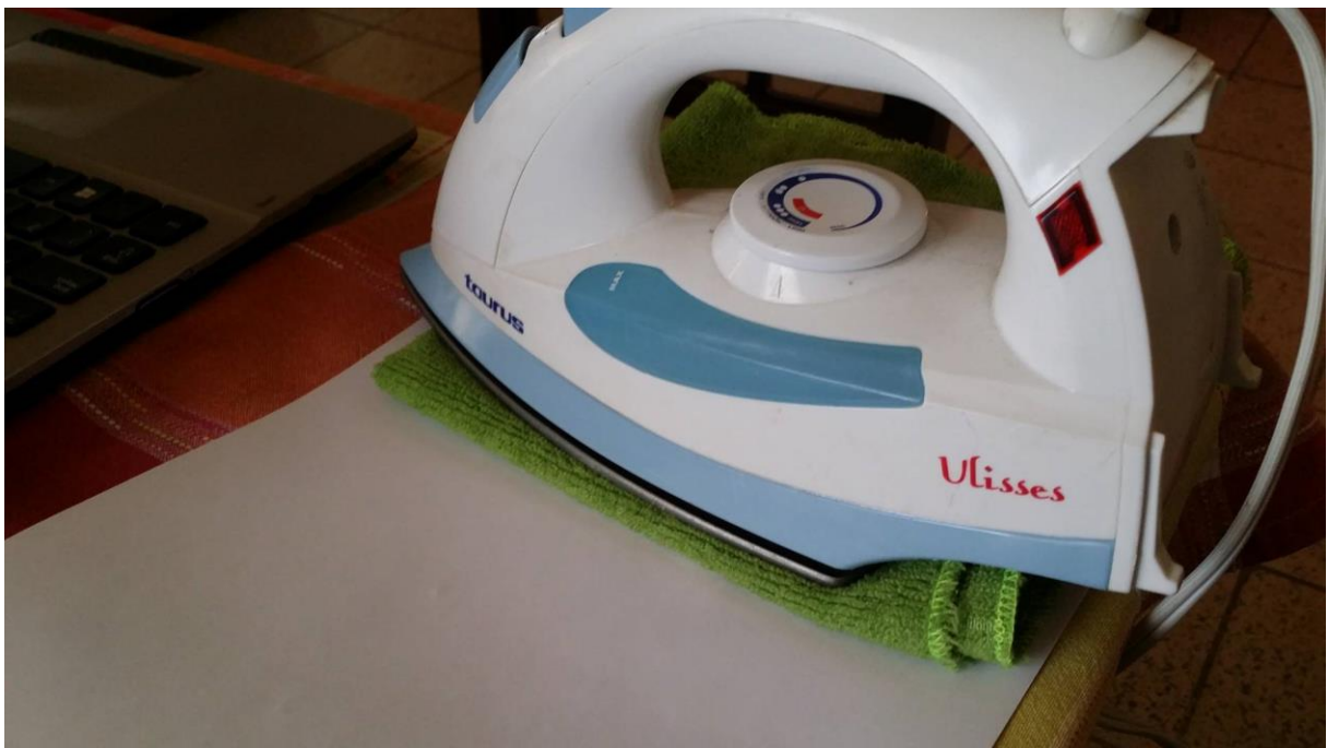
Figura 5.9 método de planchado para impresión de pcb
