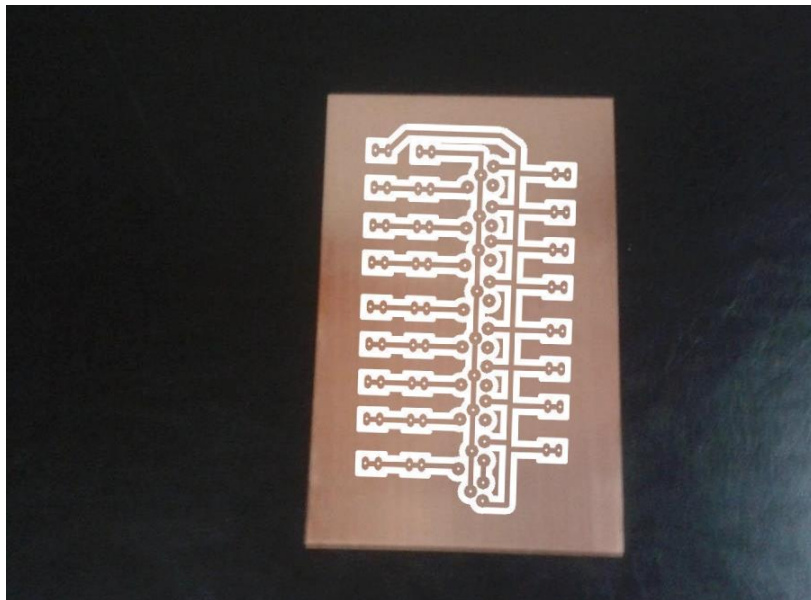
Figura 5.11 circuito impreso después del proceso de ácido férrico
