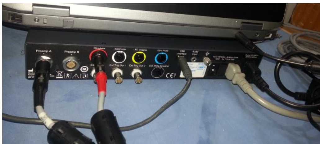
Figura 5.16 Conexiones Consola principal NIM
