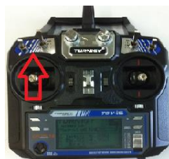
Figura 4.26. Calibración de ESC con palanca de arranque en posición máxima
