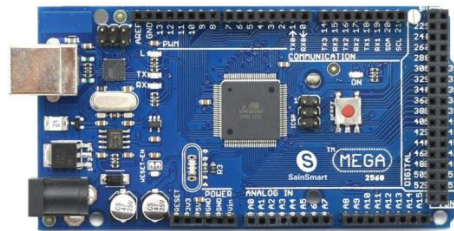
Figura 4.11. Arduino Mega 2560 (Arduino.c)
