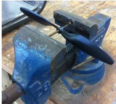
Figura 4.12. Prueba de balance en las hélices
