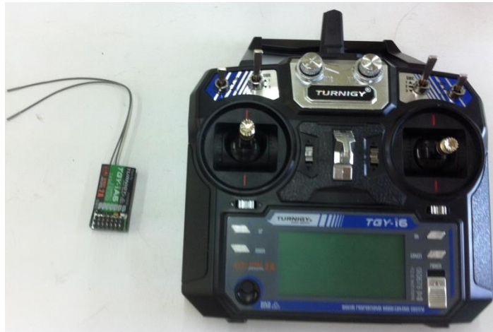
Figura 4.9. Transmisor (der.) y Receptor (izq.) RF Turnigy-i6
