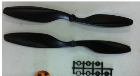
Figura 4.7. Hélices con sus respectivos adaptadores de orificio
