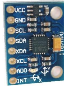
Figura 4.10. IMU MPU-6050 (Arduino)
