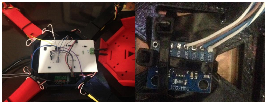
Figura 4.55. Ensamblaje completo del cuadricóptero en lazo cerrado y conexión física
