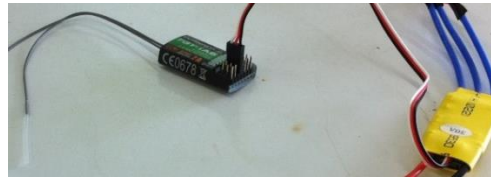
Figura 4.27. Calibración de ESC con palanca de arranque en posición máxima
