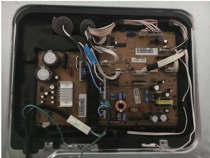
Figura 20.- PCB Main correctamente ensamblada.
