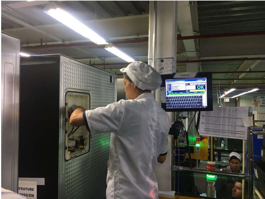
Figura 19.- Operadora colocando tarjeta PBA Main.
