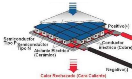
Figura 2 Componentes de una celda peltier
