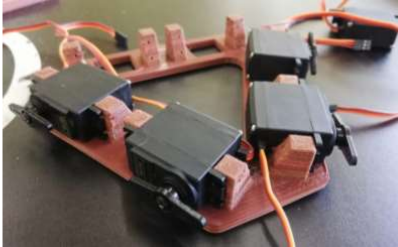
Figura 5- 1: Montura de servos en la base
