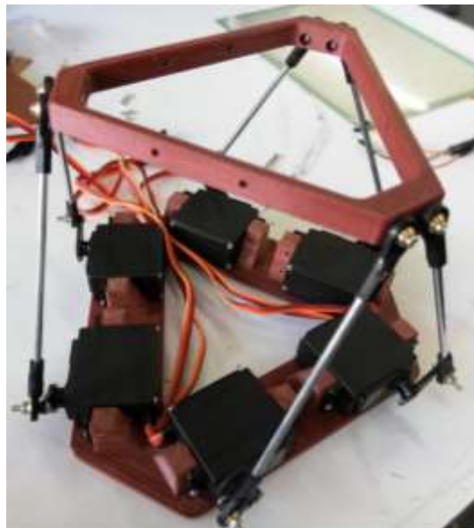
Figura 5- 2: Ensamblaje de tiradores y soporte para la base del plato
