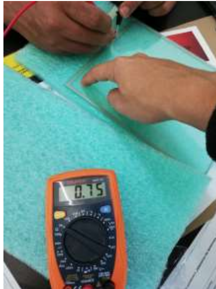
Figura 4- 1: Medición de la resistencia en la pantalla
