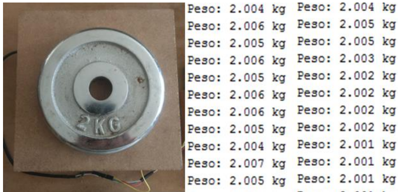
Figura 5-13 Lecturas reales del Arduino.
