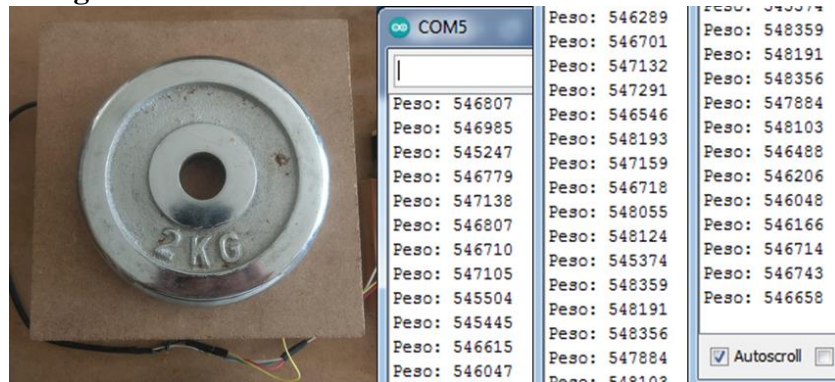
Figura 5-11 Valores del ADC obtenidos a un peso conocido.
