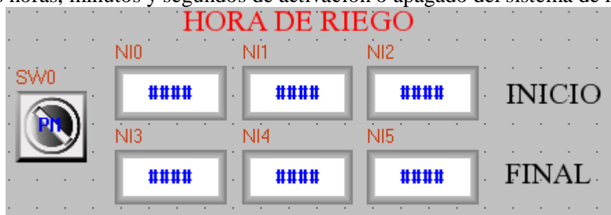
Figura 5-39 HMI de la configuración de los horarios de riego.
