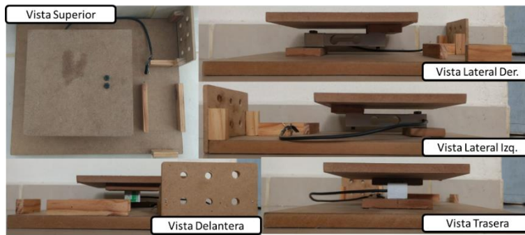
Figura 5-5 Vistas generales de la estructura del lisímetro.
