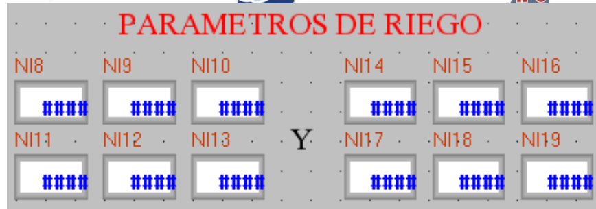
Figura 5-40 HMI de los horarios de riego.
