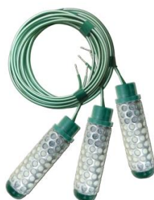
Figura 3-4 Sensores de humedad de matriz granular.
