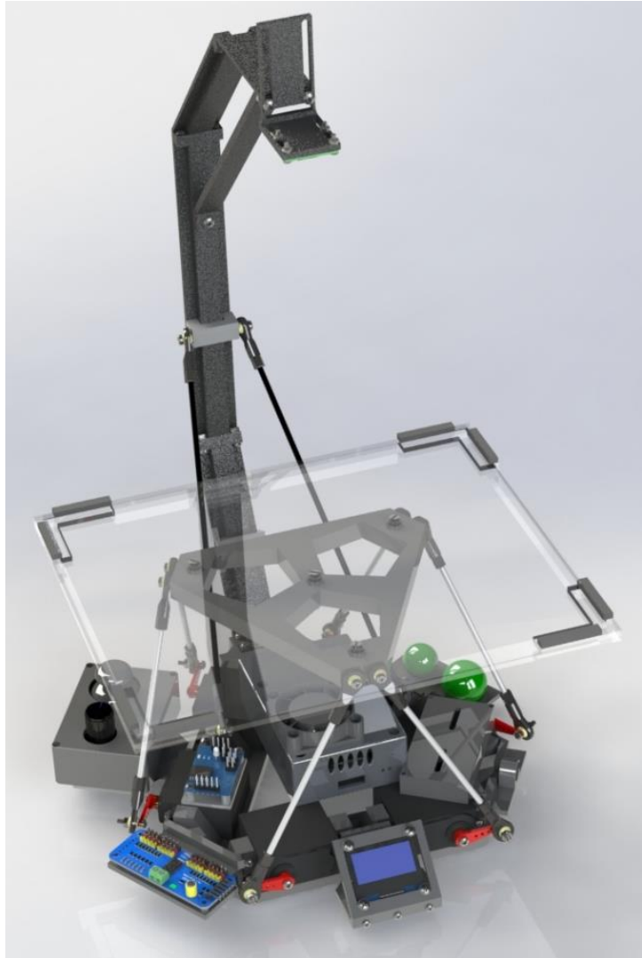
Figura 4. 12 Ball and Plate primera versión ITCG
