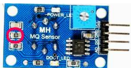
Figura 23. Resistencia R_l en Sensor de Gas MQ.
