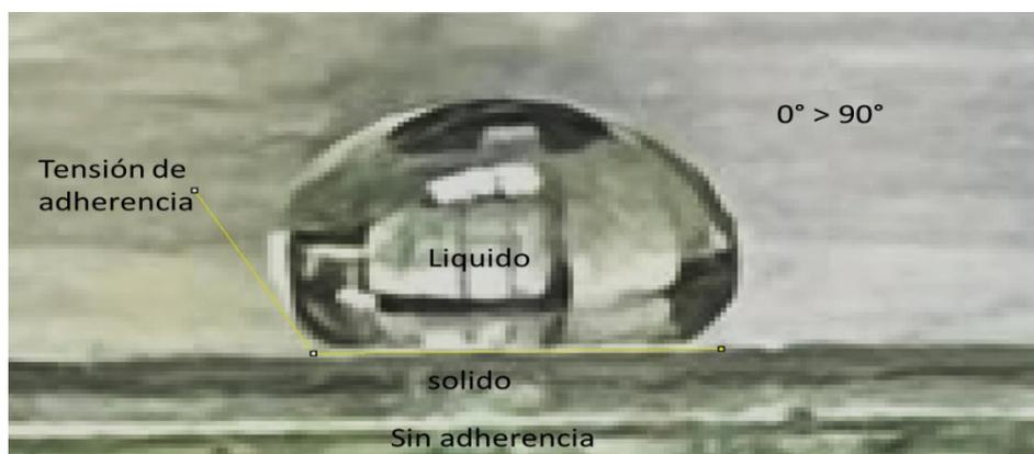
Figura 11. Ángulo de adherencia mayor a  $90^\circ$ , (elaboración propia)
