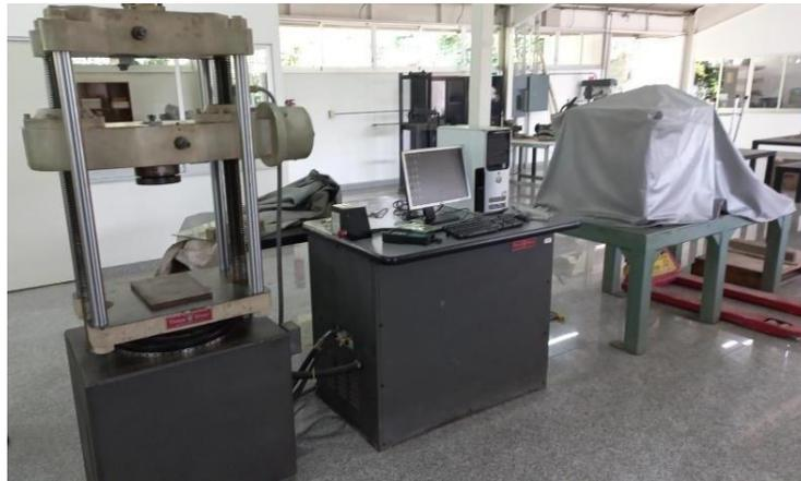
*Figura 13: Máquina universal para medir esfuerzos Tinius Olsen.*
