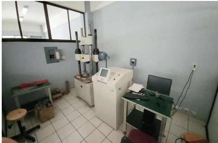
**Figura 12: Máquina para medir esfuerzos Shimadzu UH-500KNI.**
