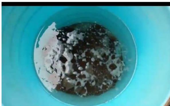
**Figura 30: Absorción con nopal 3.5 horas bloques 1% fibra.**
