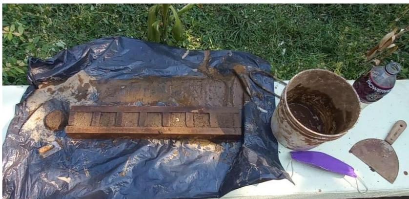
*Figura 9: Bloques de adobe para prueba mecánica simple.*
