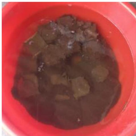
***Figura 37: Bloques de adobe con 7% de fibra 8 horas transcurrida la prueba de absorción.***
