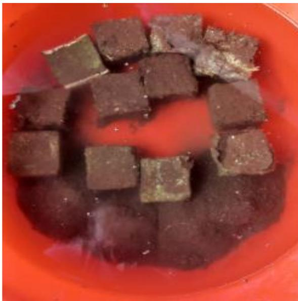
***Figura 35: Bloques de adobe destruidos transcurrida prueba absorción en 10 min.***
