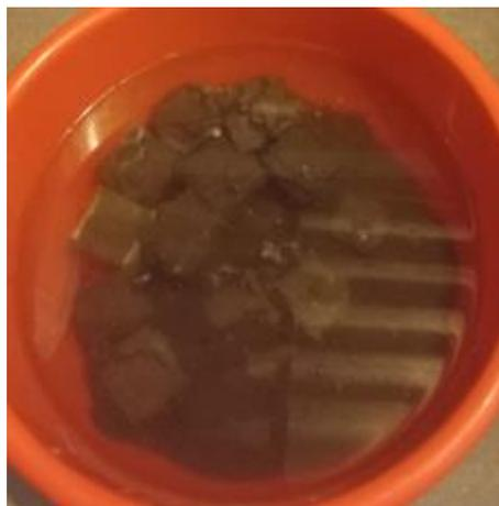
***Figura 38: Bloques de adobe con fibra y bloques de adobe con fibra y nopal siguen estables después de 13 horas iniciadas prueba de absorción.***
