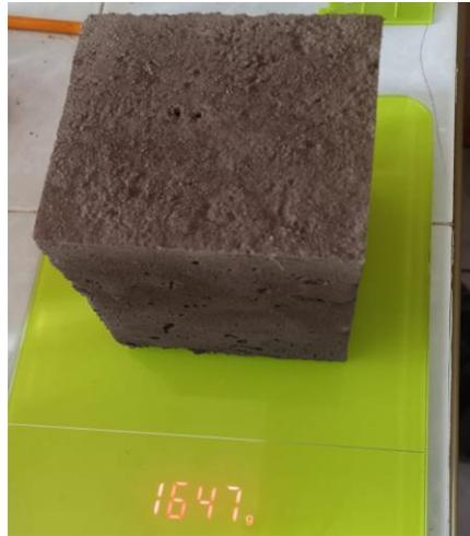
**Figura 18: Probeta agujereada para medir propiedades termo físicas.**
