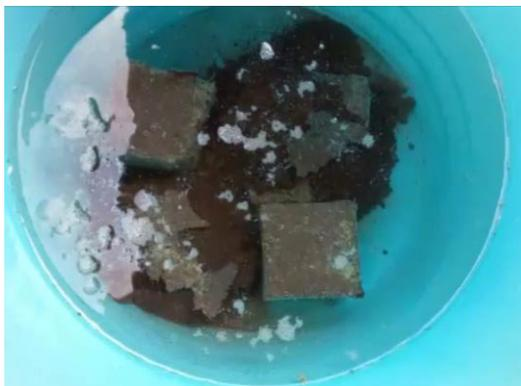
**Figura 29: Absorción con nopal 1 hora bloques 1% fibra.**
