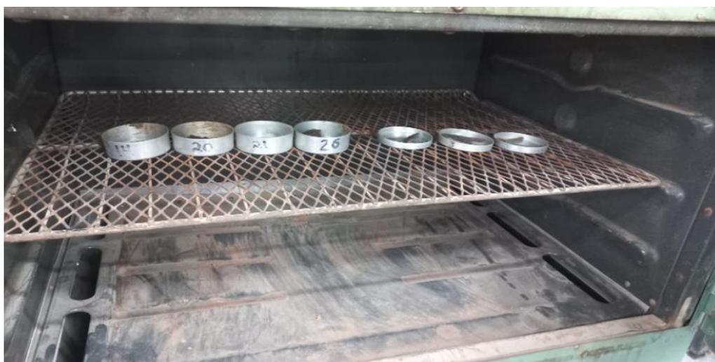
**Figura 26: Secado al horno de muestra de suelo para LL y LP.**
