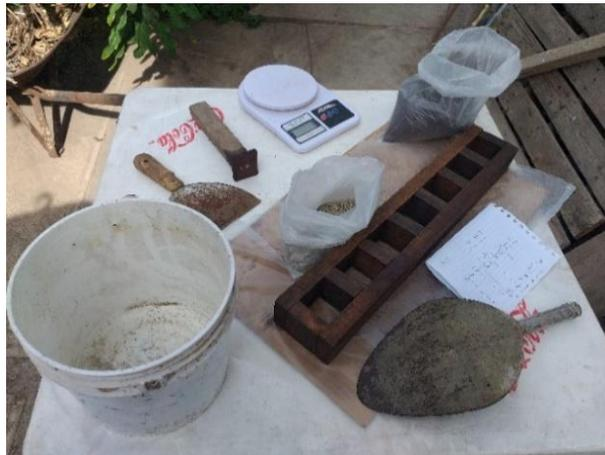
**Figura 8: Herramientas para elaborar bloques. Fuente: Elaboración propia**
