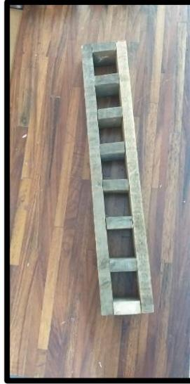
**Figura 7: Molde para bloques.**
