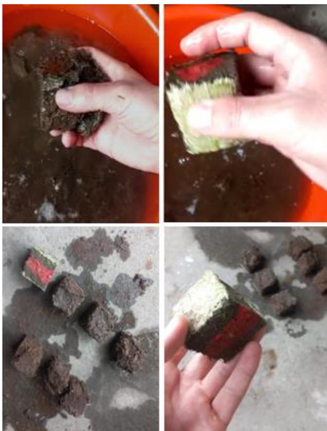
**Figura 39: Bloques de adobe con fibra y nopal soportaron la prueba en el agua durante más de 24 horas.**
