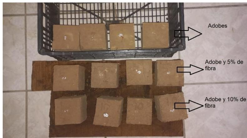
**Figura 15: Probetas prueba térmica.**
