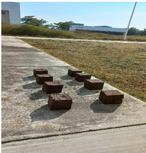
**Figura 19: Secado de probetas.**
