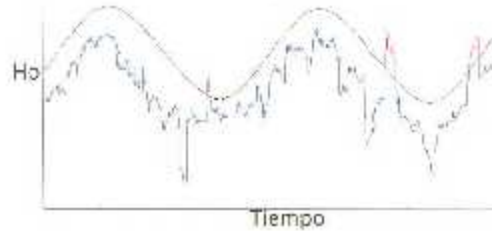
Figura 3.3 : Diagrama del control de calidad mediante valor plausible dinámico para la irradiación solar.
