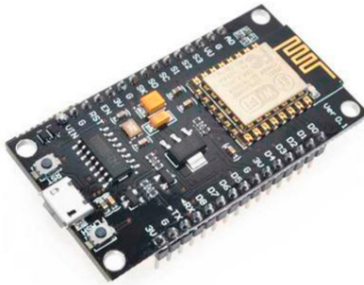
Figura 7: Configuración de pines del NodeMCU. (De La Torre Muña y Yufra Torres, 2020)
