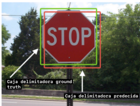
Figura 4.2: Representación visual de los parámetros necesarios para obtener la IoU
