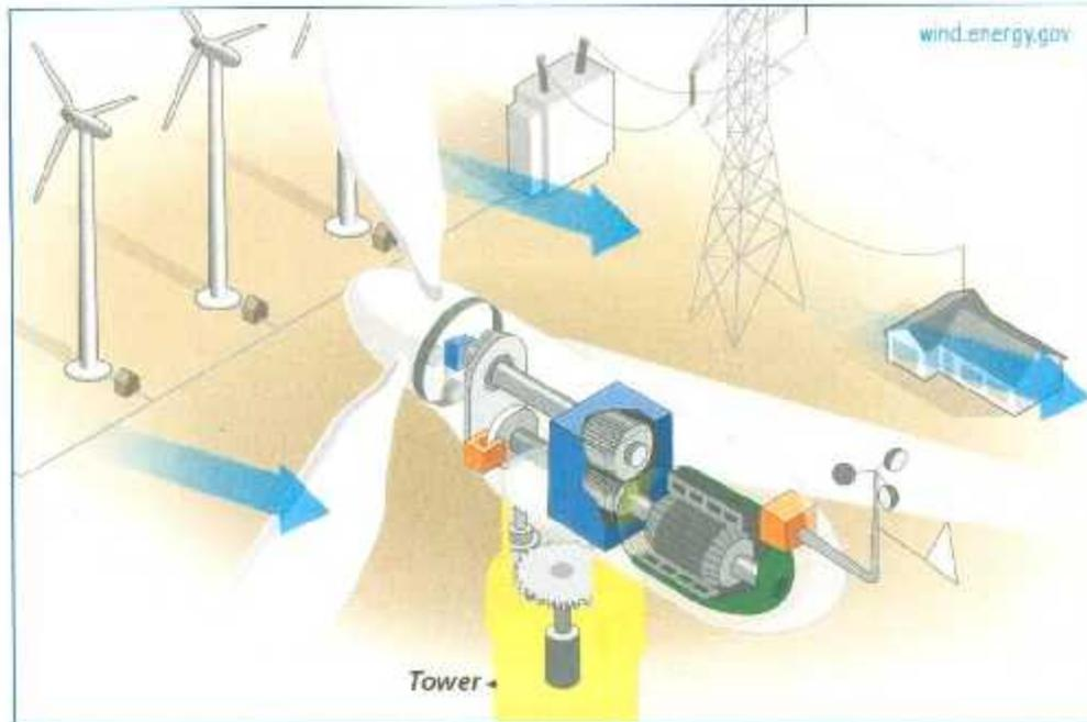
Figura 2.4 Corte transversal de un aerogenerador (Fuente: U.S. Department of Energy) [7]
