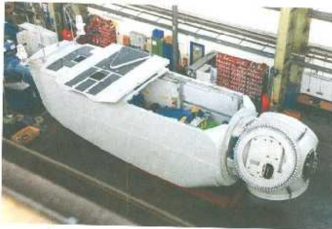
Figura 2.5 Góndola del aerogenerador N117 de la planta Nordex en Jonesboro Arkansas
