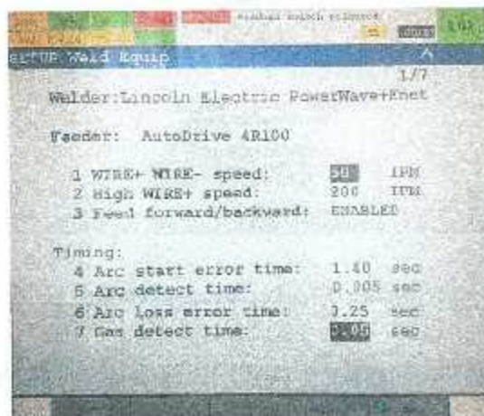
Figura 2.12: Pantalla del "Equipo de soldadura (SETUP Weld Equip)"
