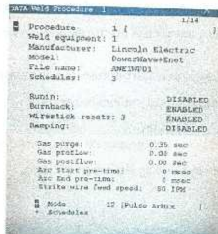
Figura 4.2: Pantalla Procedimiento de soldadura 1
