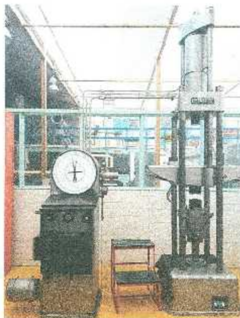
Figura A.1: Máquina de ensayo universal GATDABINI
