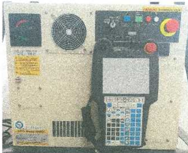
Figura 2.3: Vista externa del controlador R-30iB
