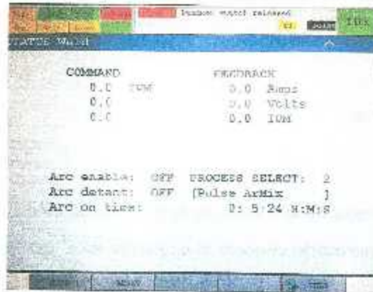
Figura 2.10: Pantalla del “Estado de soldadura (STATUS Weld)”
