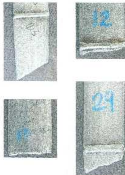
Figura 7.21: Probetas después de la prueba destructiva.
