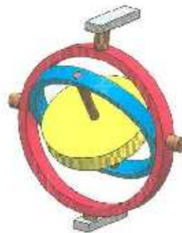
Figura 1.1: Giroscopio montado en una suspensión cardán
