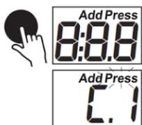
*Figura 9. Encendido del colorímetro (HANNA Instruments , 2020).*
