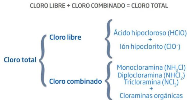
Figura 3. Diferentes formas de cloro en el agua. (HANNA Instruments, 2020).
