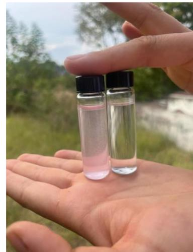
Figura 11. Reacción del reactivo DPD con el cloro en la toma de muestra.
