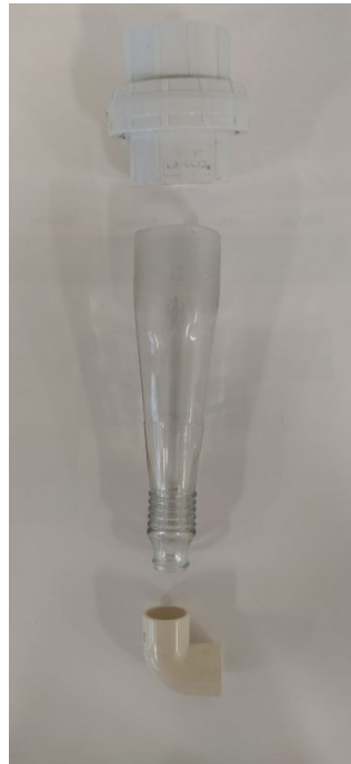
Figura 21. Cuerpo general del rotámetro.
