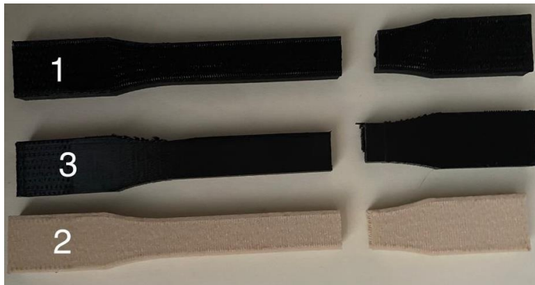
Figura 26 Probetas 50% de relleno fracturadas.
