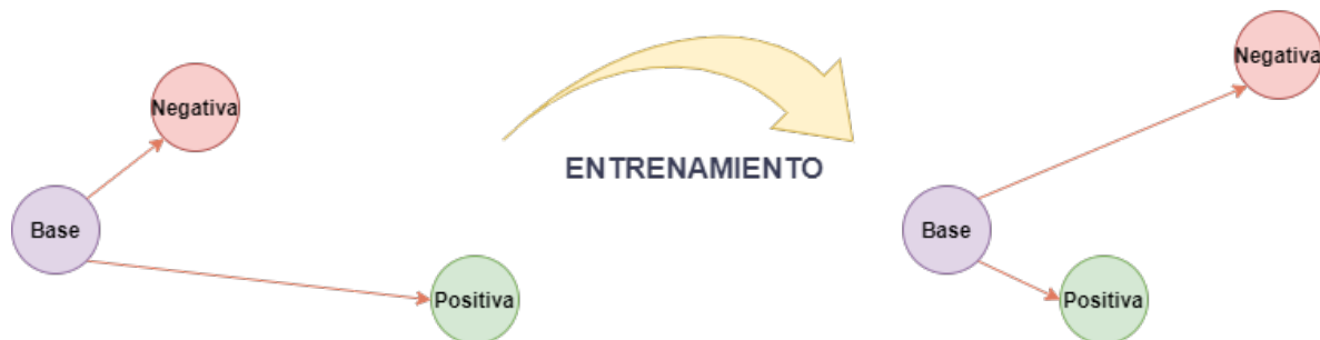
Figura 2.14: Distancias entre la imagen base, la imagen positiva y la imagen negativa (Schroff et al., 2015).
