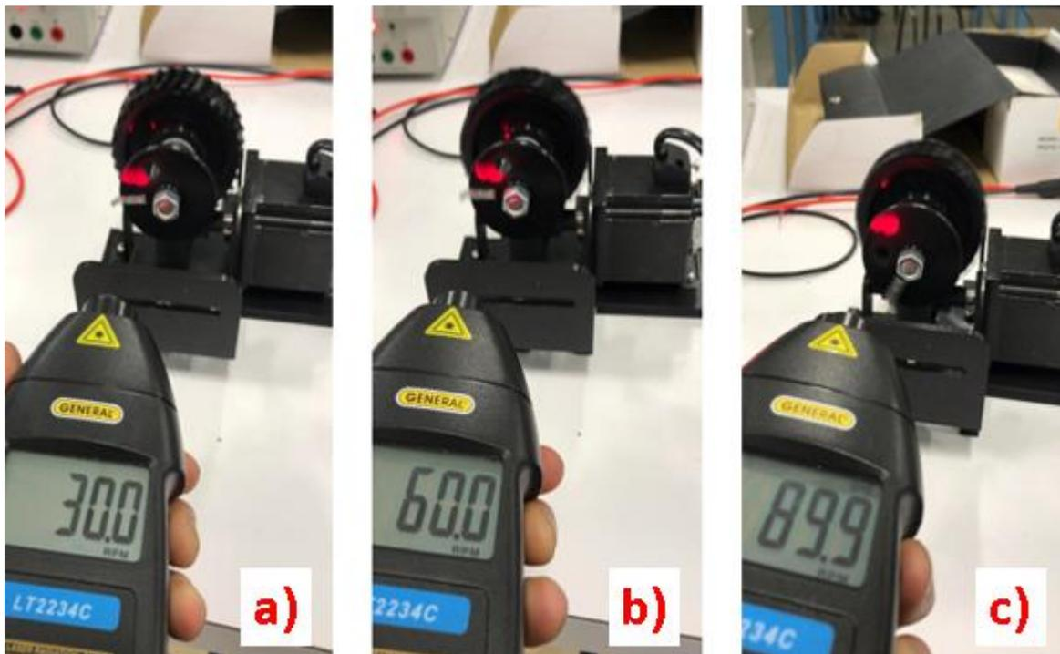
Figura 100 Tres velocidades de funcionamiento del herramental:
