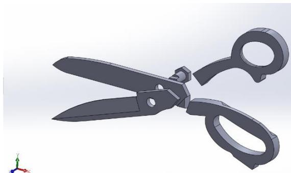
Figura 16 Vista explosiva del ensamble (Autores).
