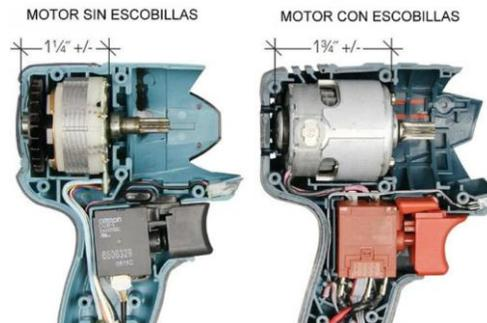
Figura 10 Motor sin escobillas y con escobillas en un taladro (De Máquinas y Herramientas, 2018).
