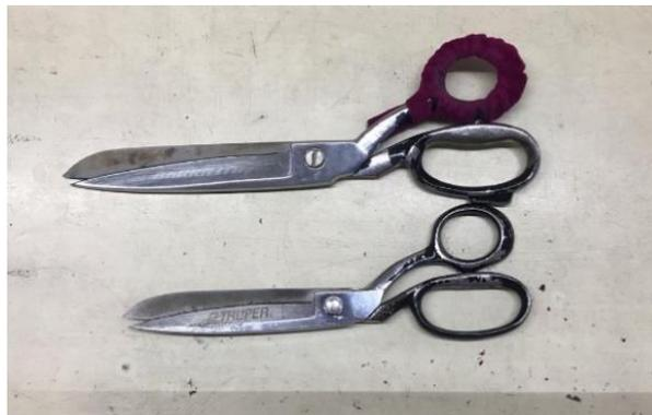
Figura 14 Tijeras generalmente usadas por los operadores para corte textil. (10';12') (Autores).
