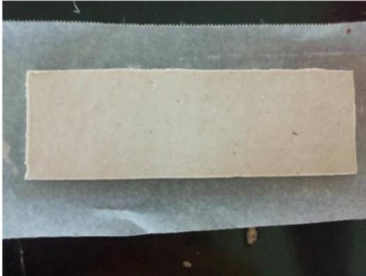
En la Imagen 3, se muestra la probeta que fue expuesta en la lámpara UV por 1700 horas categoría alcanzada 50 B.
