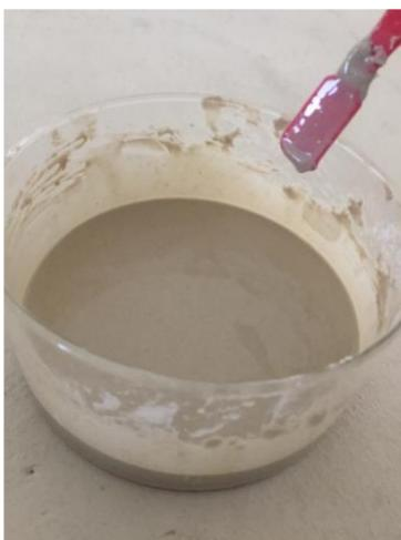
En la Imagen 1, se muestra la mezcla precisa para la realización de las películas base, para las pruebas de interperismo acelerado y resistencia a la tensión y porcentaje de elongación.
