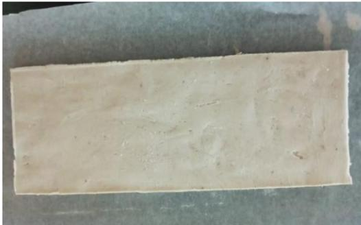
En la Imagen 4, se muestra la probeta que fue expuesta en la lámpara UV por 1300 horas categoría alcanzada 25 B.
