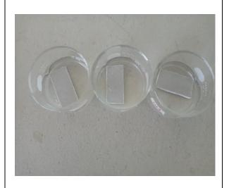
Colocación de las probetas en los cristalizadores con agua destilada.
