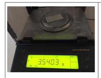
Probeta colocada en la báscula analítica para así obtener los resultados del peso de cada probeta.
