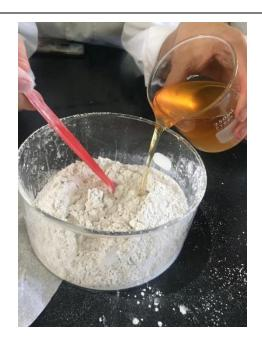
Realización de la mezcla del sebo de toro y la cal para obtener el impermeabilizante.
