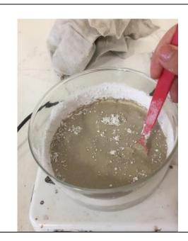
Aplicación de calor a la mezcla para obtener una mezcla homogénea
