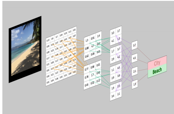
Figura 2.8: Proceso de clasificación de CNN. Tomado de Patterson & Gibson, 2017
