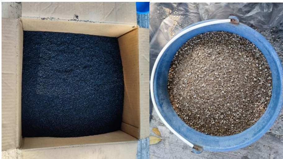
Imagen 17. Partículas de caucho y jal despues del cribado.
