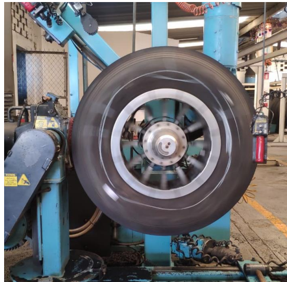
Imagen 8. Proceso de rayado de neumáticos para la obtención de caucho.
