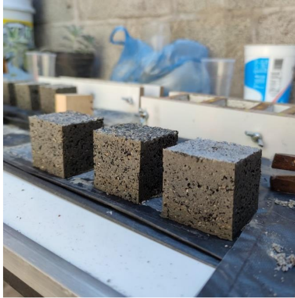
Imagen 23. Probetas después de la extracción del molde.
