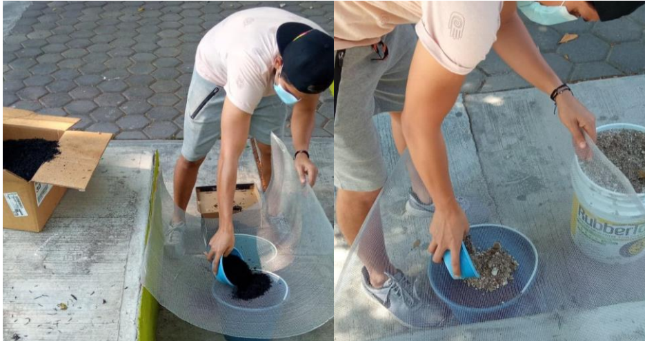
Imagen 16. Cribado del caucho y el jal.
