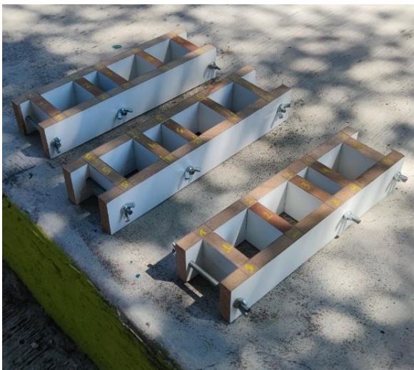
Imagen 13. Molde de madera que se utilizó para crear las probetas.
