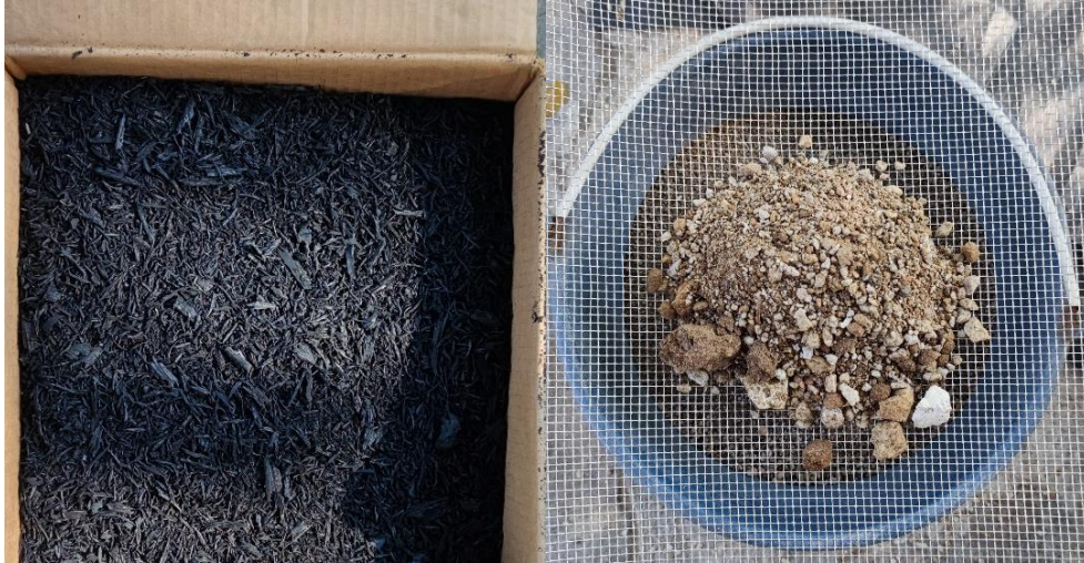
Imagen 15. Partículas de caucho y jal antes de cribar.
