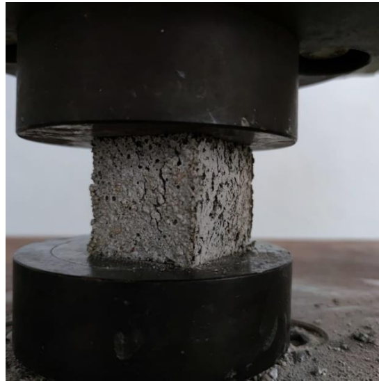
Imagen 29. Proceso de prueba en el equipo. Probeta con carga aplicada.
