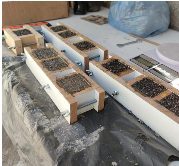
Imagen 22. Moldes después de colocar de la mezcla y prensarlos.
