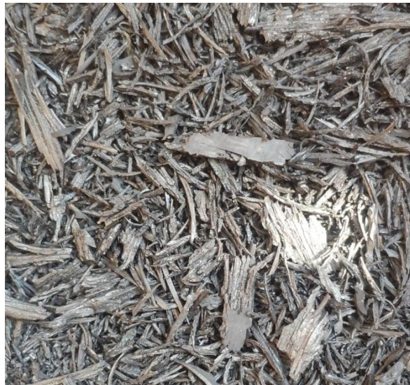
Imagen 6. Caucho triturado obtenido de neumáticos.
