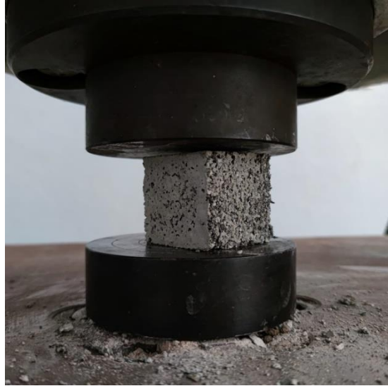
Imagen 28. Probeta siendo ensayada en la prensa universal.
