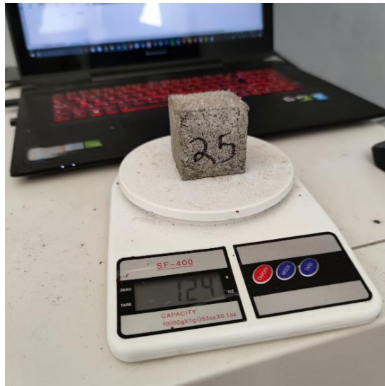
Imagen 27. Pesado de probetas.
