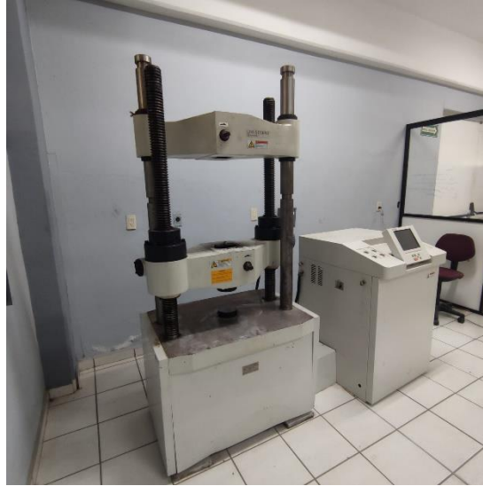
Imagen 26. Maquina universal UH – 500 kNI marca SHIMADZU.
