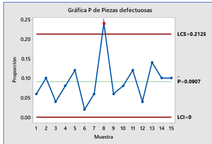
Figura 3.6.- Gráfico de control de la fracción defectuosa de piezas fabricadas.
