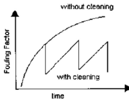
Figura 8. Ensuciamiento de la HRSG en el tiempo
