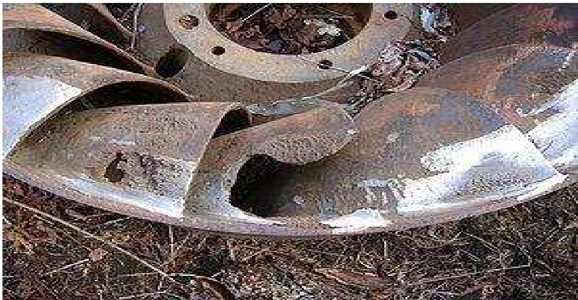
Figura 3 Daño por cavitación de una turbina Francis.
