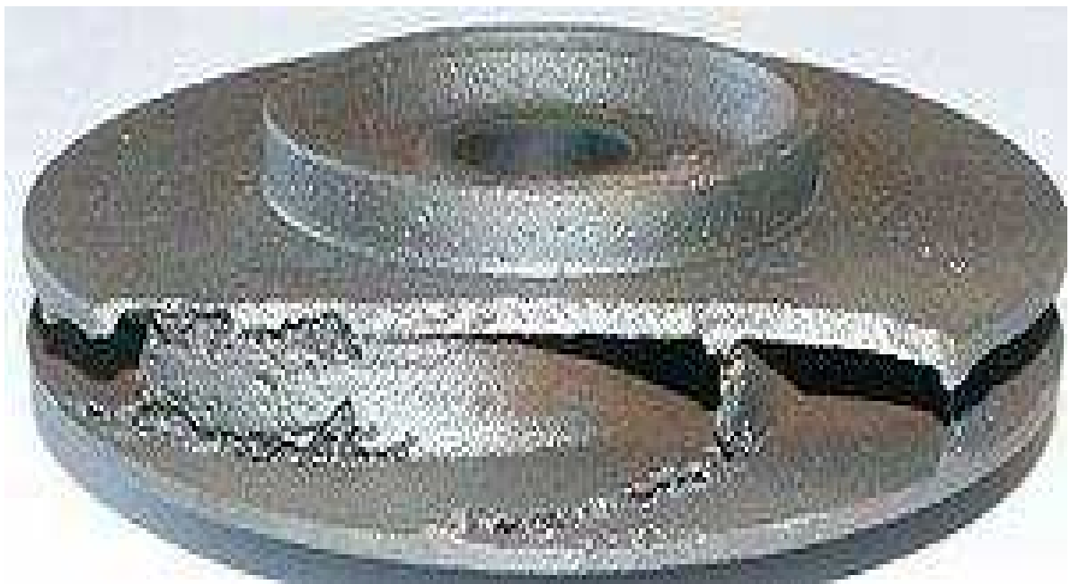
Figura 4 Desgaste producido por la cavitación en un rodete de una bomba centrífuga.
