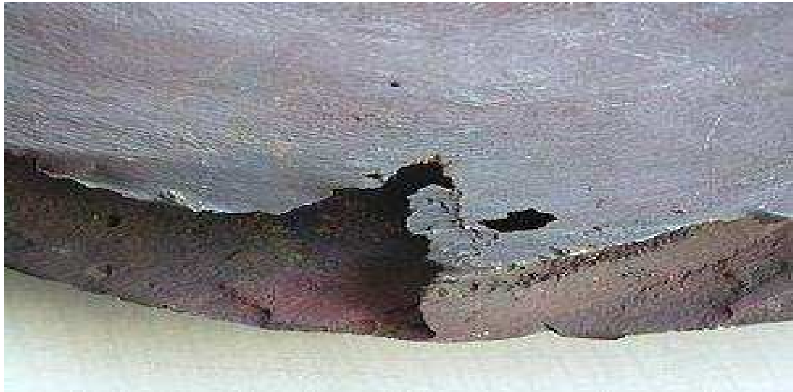
Figura 4 Desgaste producido por la cavitación en un rodete de una bomba centrífuga.
