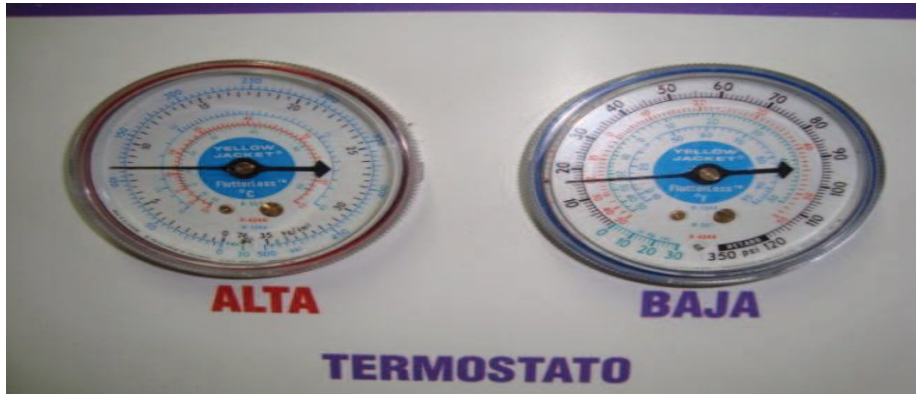
Figura 3.7 Manómetros, presión alta, salida del compresor (que es teóricamente igual a la presión de entrada y salida del condensador,) y presión baja, entrada del compresor (que es teóricamente igual a la presión de entrada y salida del evaporador)
