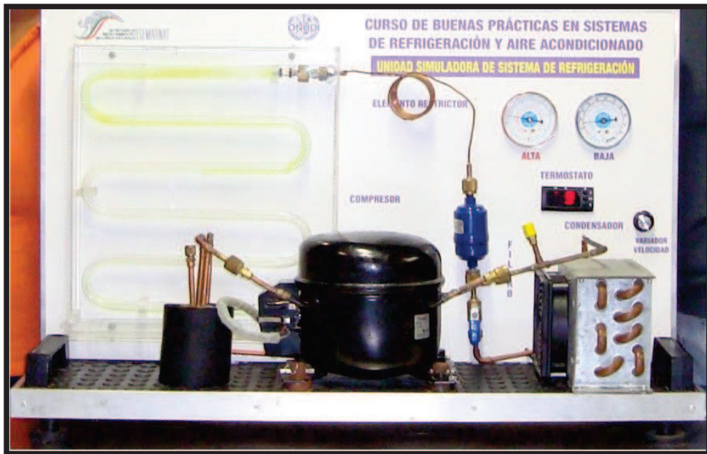
Figura 3.2 Unidad Simuladora de Sistemas de Refrigeración, en la cual se aprecia cada uno de los elementos que conforman el ciclo.
