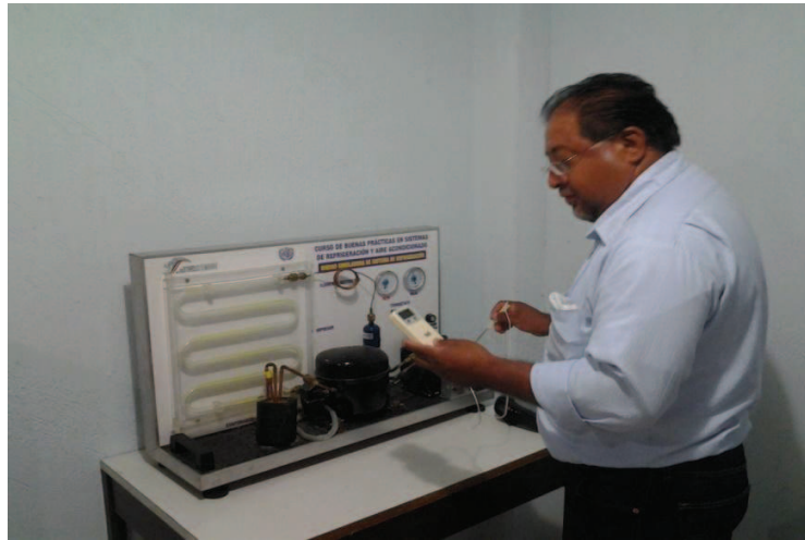
Figura 3.38. El autor midiendo la temperatura salida del compresor
