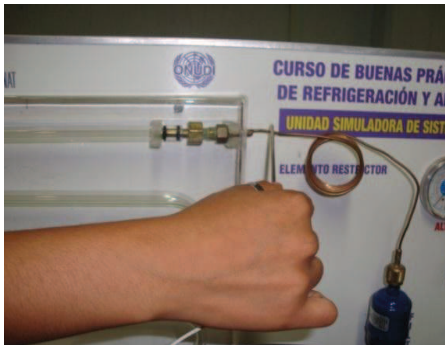
Figura 3.10. Midiendo la temperatura de entrada en el evaporador
