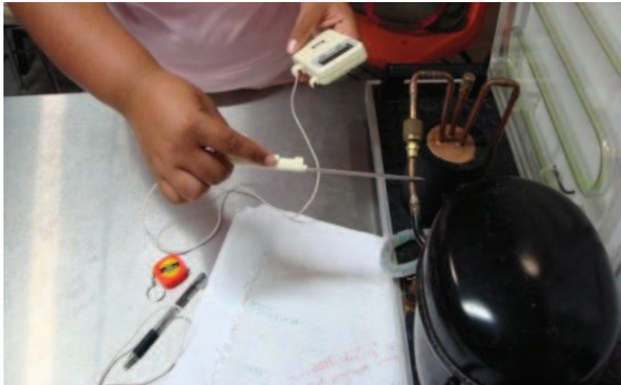
Figura 3.8. Midiendo la temperatura de entrada en el compresor
