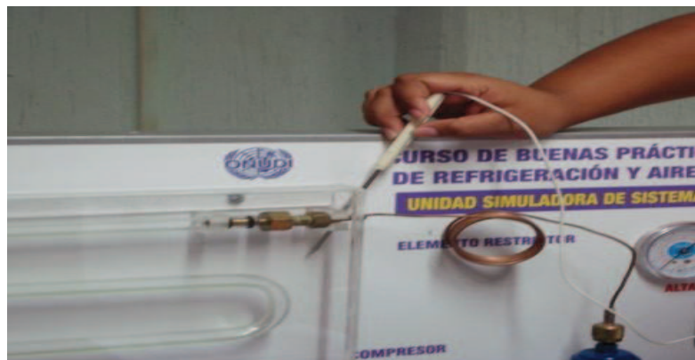
Figura 3.6 Midiendo la temperatura en la caja. Antes de iniciar el ciclo.
