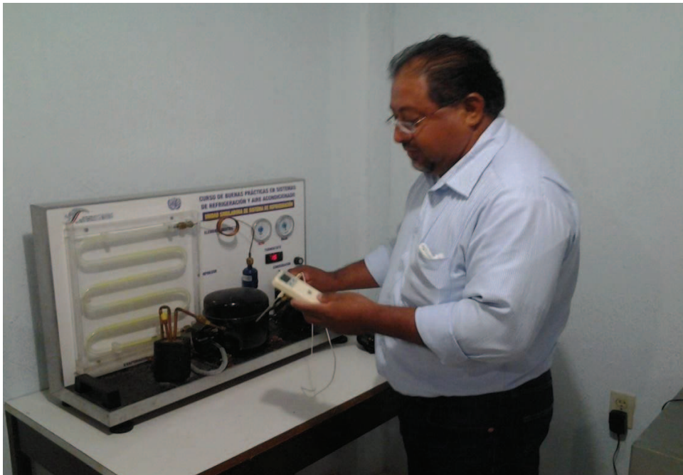
Figura 3.37 El autor midiendo la temperatura en el compresor
