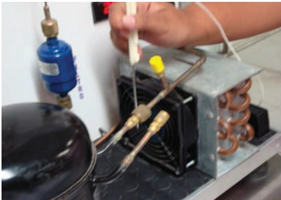
Figura 3.12.Midiendo la temperatura de entrada en el condensador
