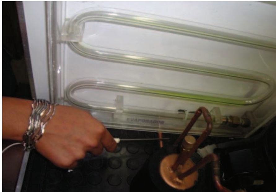
Figura 3.11.Midiendo la temperatura de salida en el evaporador
