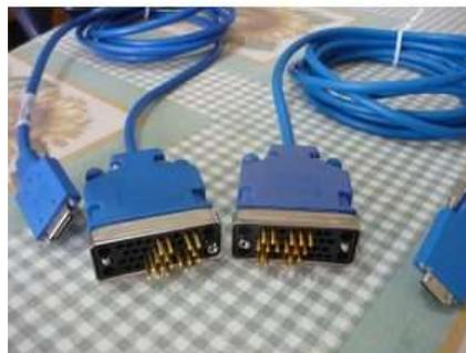
**Paso 2: Conecte el extremo DCE del cable serial nulo a la interfaz serial 0/0/0 del router R1 y el extremo DTE del cable serial nulo a la interfaz serial 0/0/0 del router R2.**
