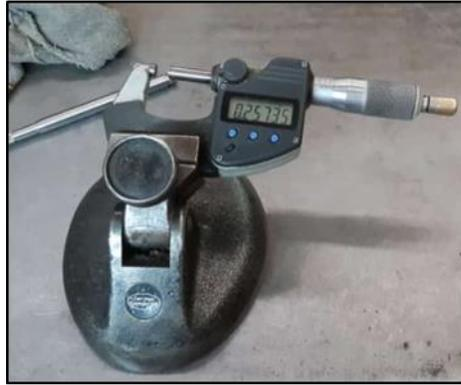
*Figura 17. Micrómetro apoyado en base para poder tomar lecturas correctamente.*
