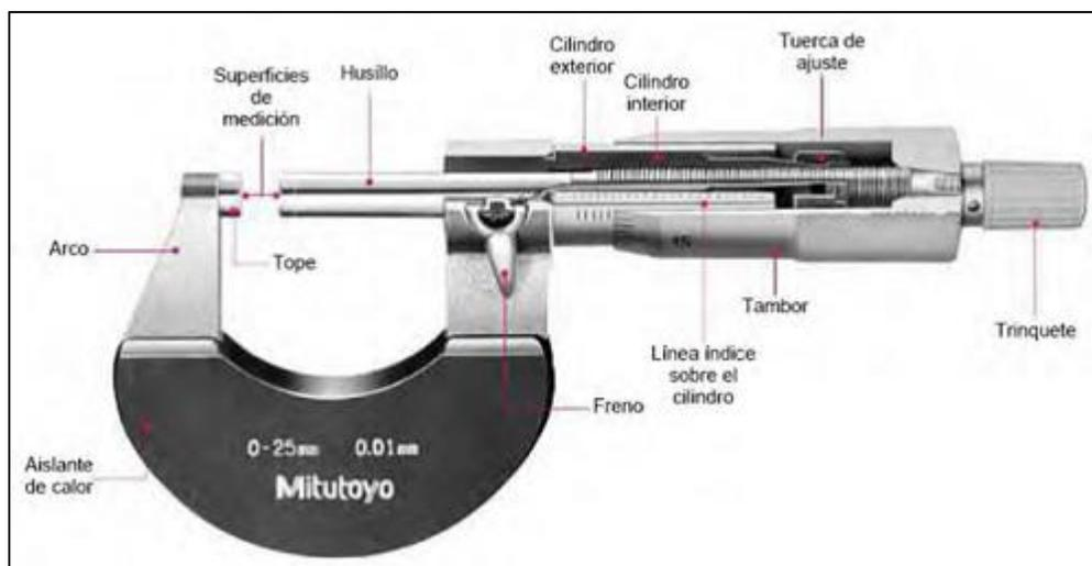
Figura 21. Partes de un micrómetro estándar, se indica la zona de apriete llamada trinquete.
