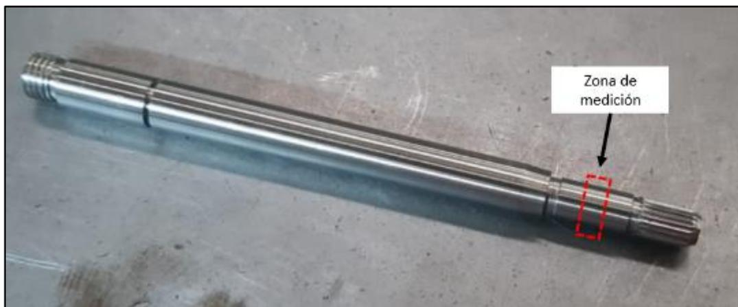
Figura 20. Flecha para motor, con indicación de donde se debe tomar la lectura del diámetro de la pista de chumacera
