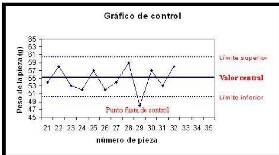
Figura 5. Representación de una gráfica de control para medir la variación de los pesos en una pieza cualquiera.
