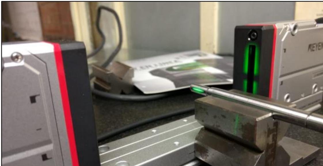
Figura 33. Se muestra como el láser del micrómetro atraviesa la zona de medición del diámetro de la flecha.
