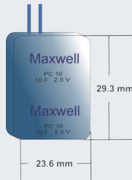
Figura 7.2: Supercapacitor electro-químico de doble capa Maxwell, con geometría prismática y capacitancia nominal de 10 F.
