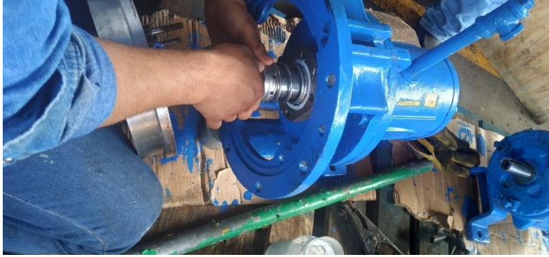
Ilustración 11. revisión del sello e impulsores fuente: propia.
