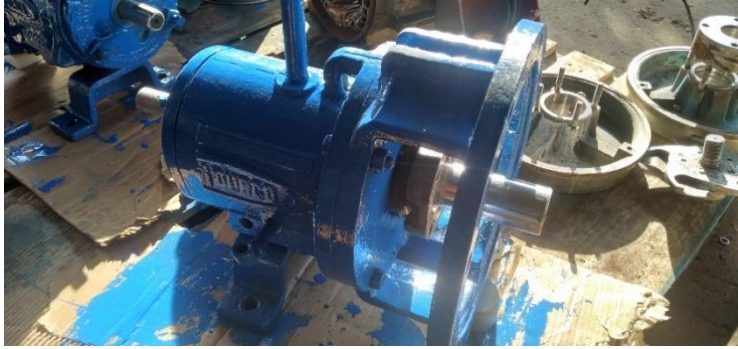
Ilustración 10. Revisión de flecha fuente: propia
