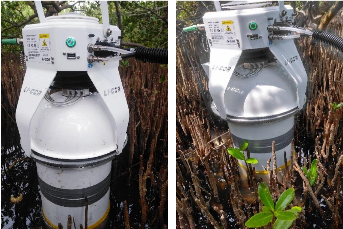
Figura 16. Cámara instalada sobre el anillo de PVC en un punto de muestreo en el manglar de transición.
