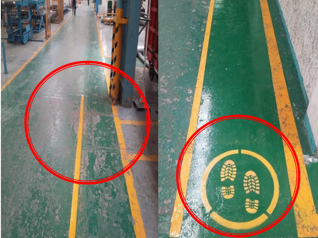
Ilustración 28. Antes y después de poner los señalamientos en pasillos Fuente: propia
