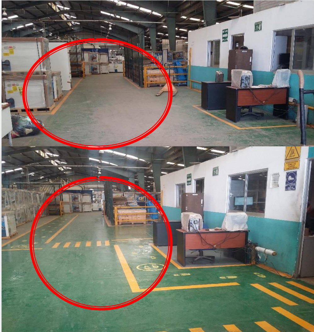
Ilustración 25. Antes y después de pintar pasillos
