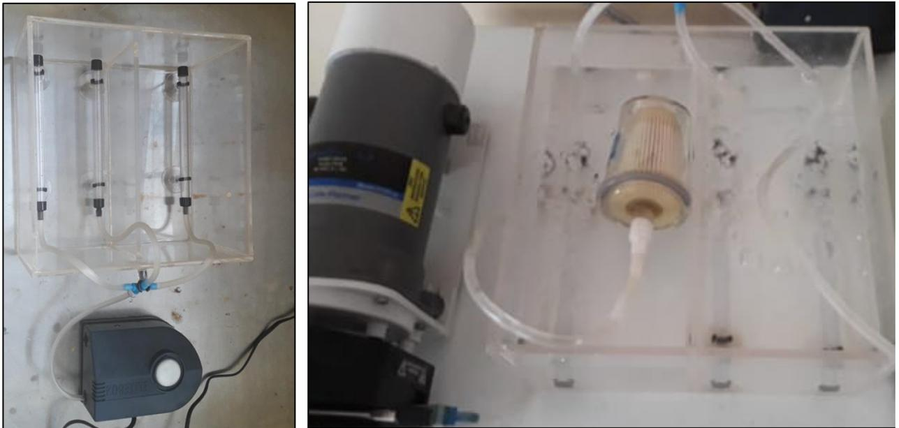
Pruebas de aireación y de fugas en el BRMs
