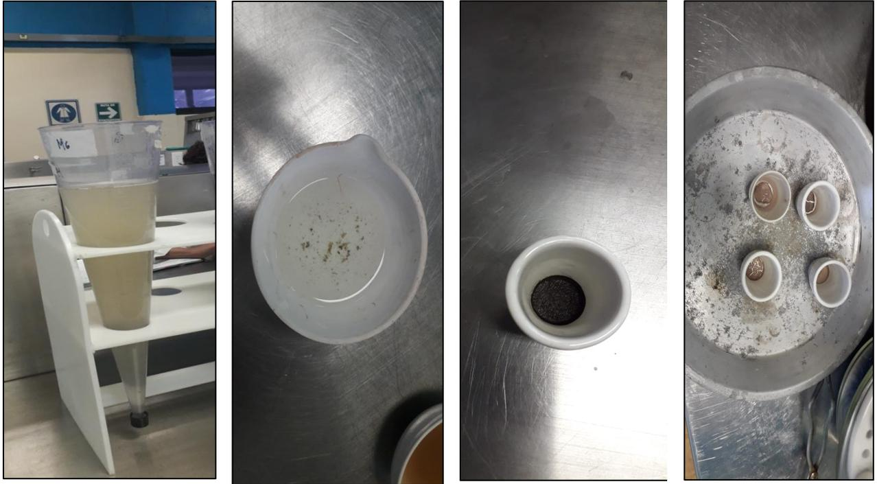
Determinación inicial de Ssed., ST, STV, SST Y SSV en el efluente.
