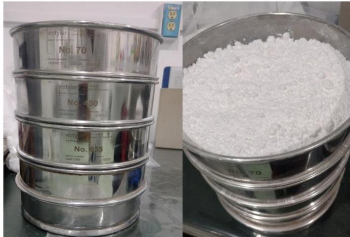
Figura 15. Tamices empleados para obtener la muestra de cristal idónea. (Morales, 2022)
