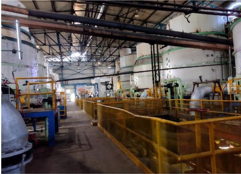
Figura 6. Tachos empleados para el proceso de Cristalización en el área de Elaboración. (Morales, 2022)
