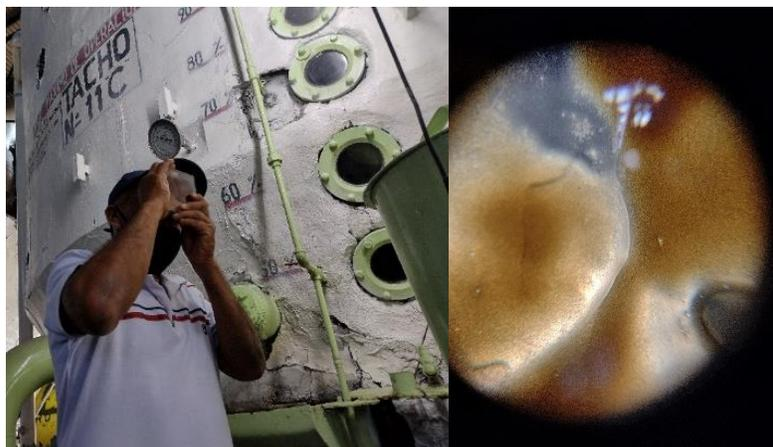
Figura 22. Tachero de turno observando la muestra de Masa Cocida de C. (Morales, 2022)
