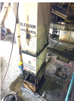
Figura 4-22.: Cajones correctamente alineados en base
