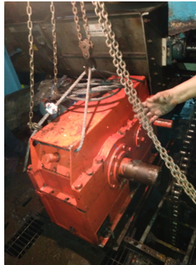
Figura 4-34.: Reductor de velocidad Falk.
