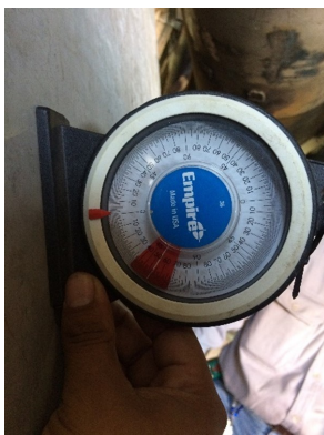
Figura 4-54.: Caída de azúcar con 52^\circ de inclinación.
