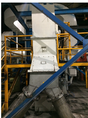
Figura 4-27.: Cajones de descarga de elevador de azúcar húmeda.
