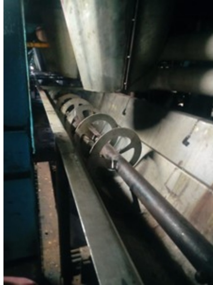
Figura 3-5.: Transportador helicoidal de azúcar húmeda de A.
