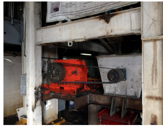
Figura 4-57.: Transmisión Tipo: Falk 2090 Y2 (Plan B), Primera sección transportador helicoidal.
