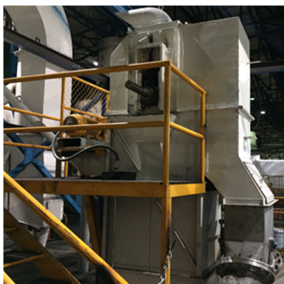
Figura 4-28.: Orientación de gargantas de azúcar húmeda a los secadores.
