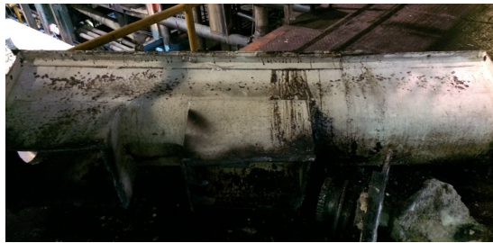
Figura 4-18.: Retiro de artesa de gusanitos.
