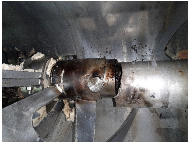
Figura 3-13.: Fractura de listón helicoidal de azúcar húmeda de A.
