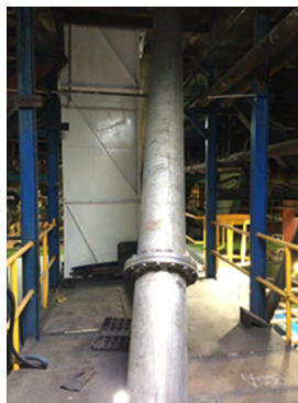
Figura 4-30.: Tubo de caída de azúcar ubicado en secador 1.
