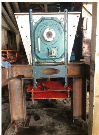
Figura 4-48.: Transmisión, Dodge TA6307H15, Primera sección transportador helicoidal.
