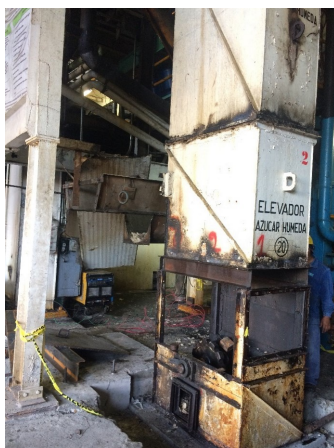
Figura 4-38.: Artesa de transportador helicoidal alineada con elevador de azúcar.
