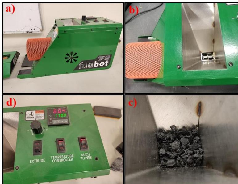
**Figura 46.** a) Extrusora Filabot EX2, b) Tolva sin material, c) Tolva con material PLA/MWCNT<sub>f</sub>, d) Configuración del equipo.
