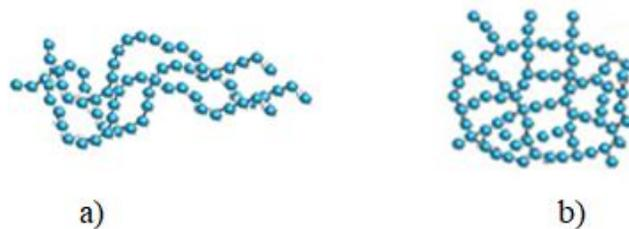
**Figura 6.** Cadenas de los polímeros termoplásticos (a) y termofijos (b), respectivamente.
