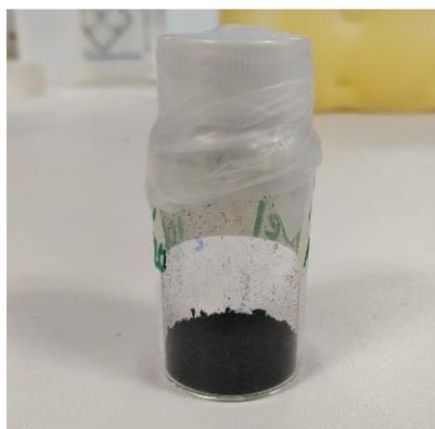
**Figura 38.** MWCNT sintetizados.
