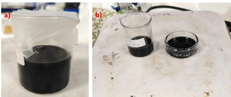
**Figura 42.** Dispersión de PLA/MWCNT<sub>f</sub> antes (a) y durante el secado (b).
