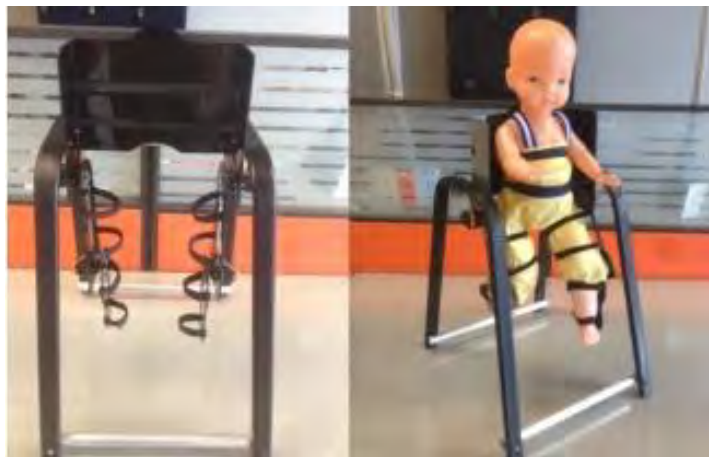
Figura 8. Exoesqueleto rehabilitador para niños de Cornejo [6]
