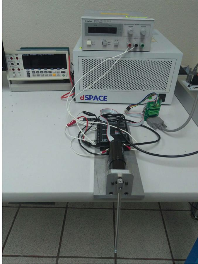
**Figura 4.2:** Configuración experimental que muestra el sistema de péndulo y el sistema de dSPACE<sup>®</sup> entrada/salidas.
