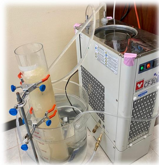
Figura 7. Biorreactor Airlift trabajado a temperatura 19°C
