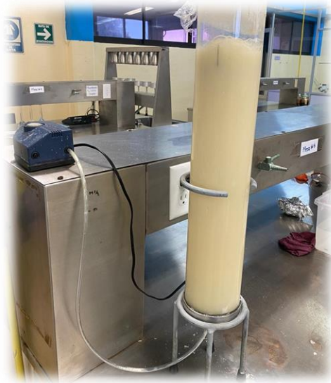
Figura 6. Biorreactor airlift a temperatura ambiente (26°C)
