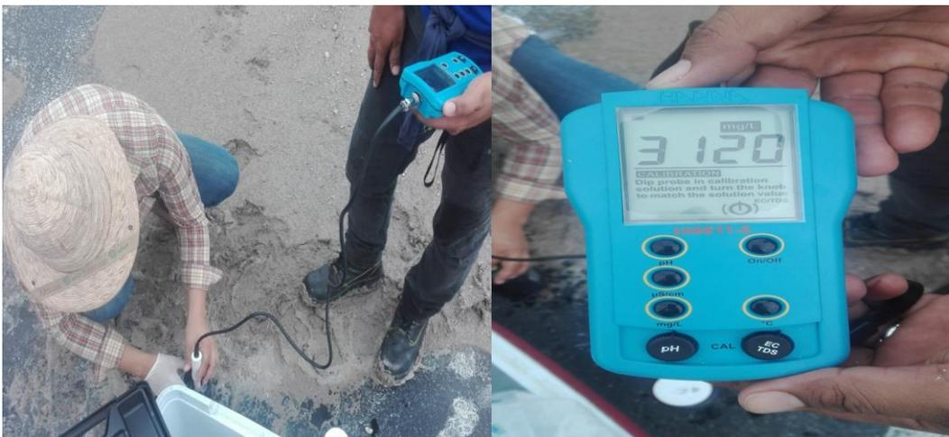
Figura 18. Medición de pH, temperatura, conductividad y sólidos suspendidos totales *in situ*
