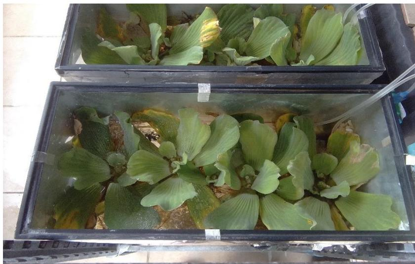
Figura 22. Pruebas de fitorremediación
