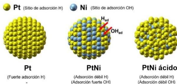
Figura 7. Esquema de las nanopartículas modelo de Pt, PtNi y PtNi ácido
